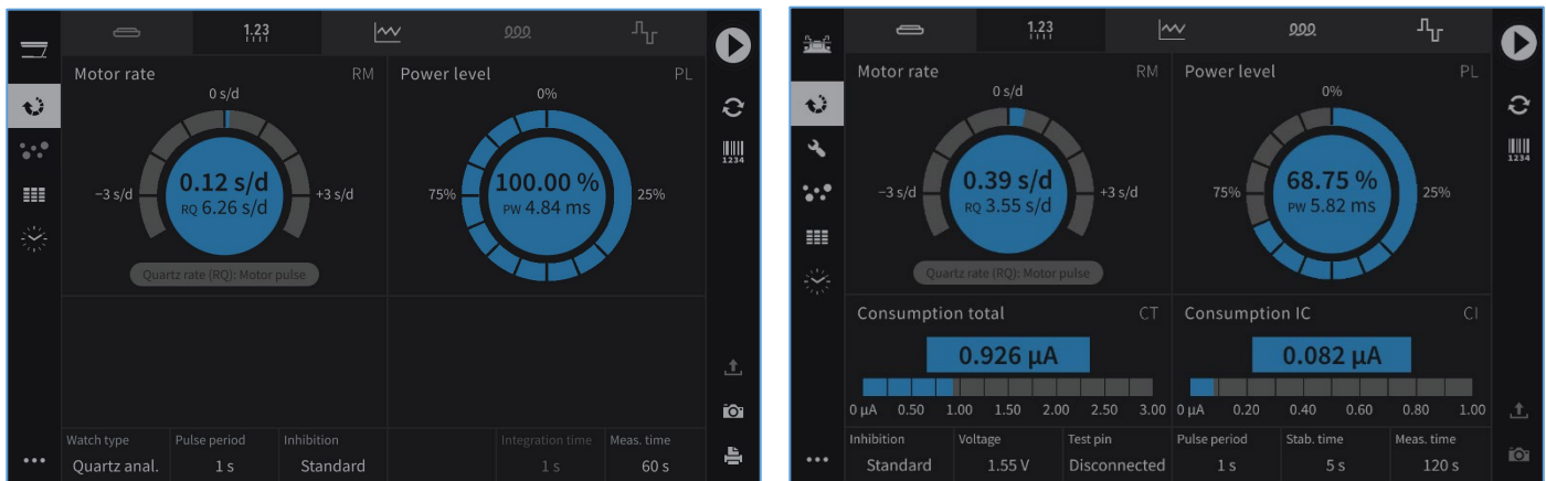
Abbildung 32: Messung der Gangabweichung Motor (RM), Gangabweichung Quarz (RQ), Leistungsstufe (PL) und Impulsdauer (PW) Links: Mit QuartzSensor/Terminal über einen induktiven/kapazitiven Aufnehmer. Rechts: Mit QuartzMaster®/Terminal über die Strommessung.
