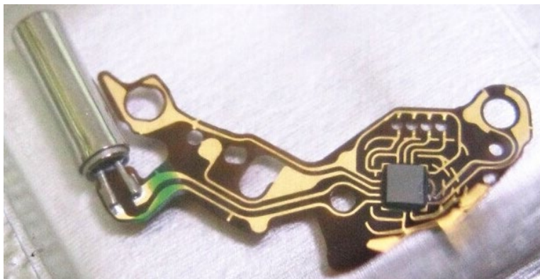
Abbildung 26: Bild der Leiterplatte mit Uhren-IC und Abgleich durch Zuschalten von integrierten Festkondensatoren durch Lötbrücken.
