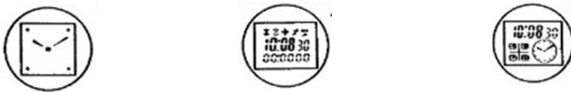
Abbildung 23: Links: Elektronische Darstellung von Zeigern. Mitte: Zeitanzeige mit Ziffern. Rechts: Kombination von Zeigerdarstellung und Ziffern.
