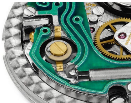
Abbildung 25: Links: Bild eines variablen Kondensators auf einem Uhrwerk. Rechts: Blockscheema einer analogen Quarzuhr mit variablem Kondensator.
