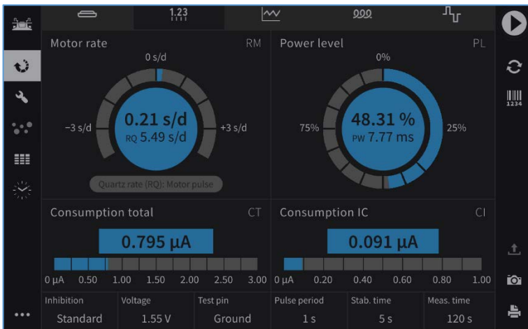
Abbildung 31: Stromaufnahme einer Quarzuhr. Totalstrom (CT) und IC-Strom (CI)
