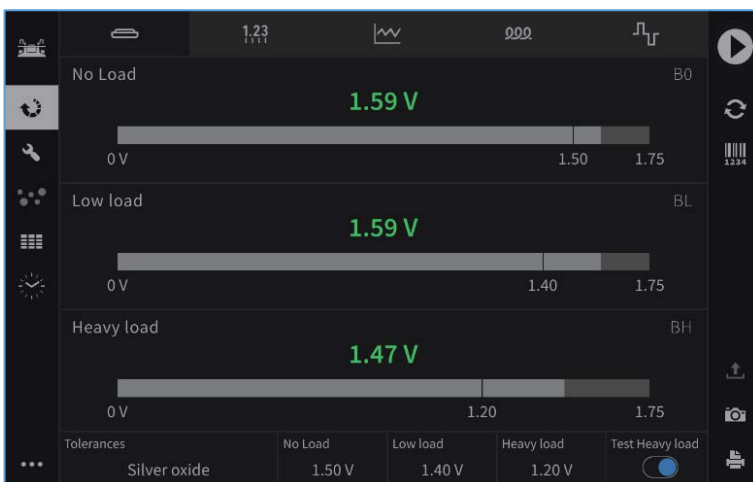
Abbildung 30: Batteriespannungsmessung ohne Last, mit geringer Last und hoher Last.
