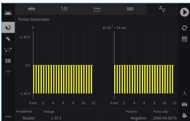
Abbildung 39: Modus Pulsgenerator beim Generieren eines Piezosignals.
