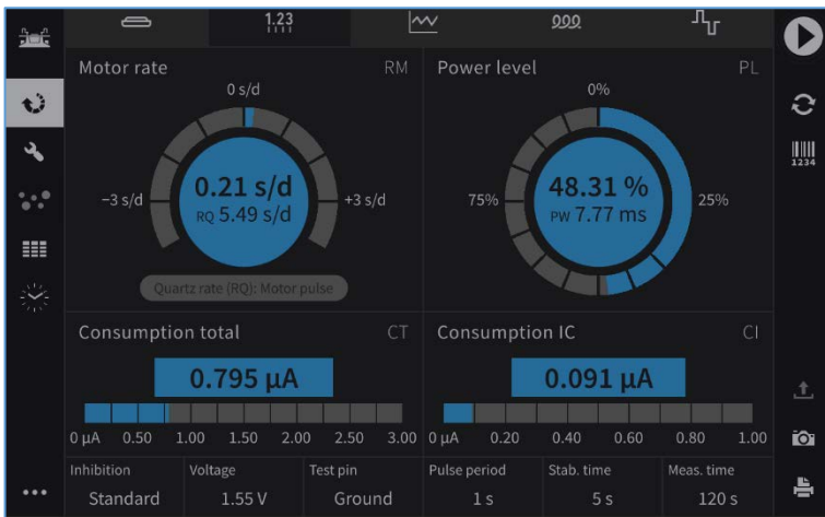
Figure 31 : Consommation de courant d'une montre quartz. Courant total (CT) et courant du circuit intégré (CI)
