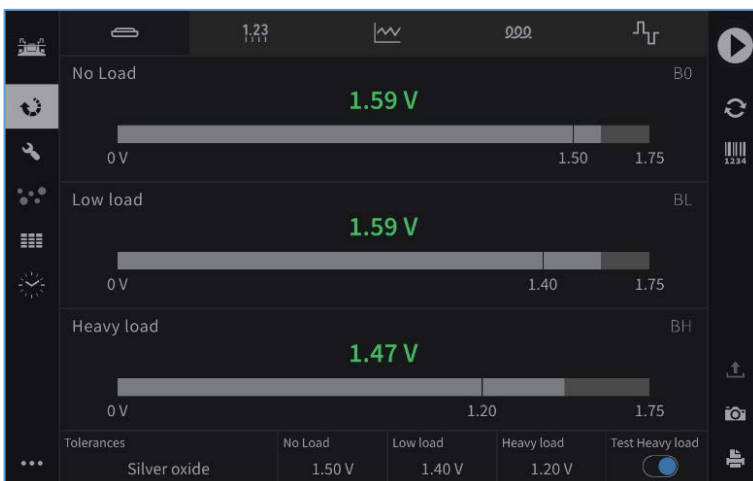
Figure 30: Mesure de la tension de la batterie sans charge, à faible charge et à charge élevée.
