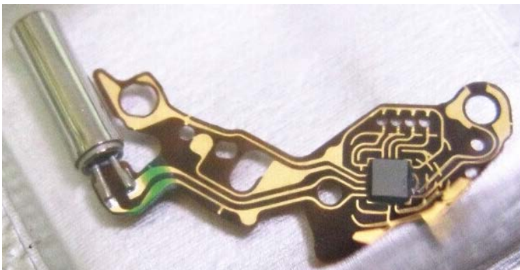
Figure 26: Image du circuit imprimé avec le CI de l'horloge et l'équilibrage par la mise en circuit de condensateurs fixes intégrés par des ponts de soudure.
