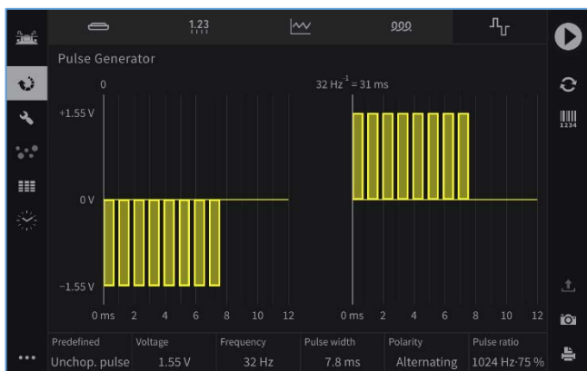
Figure 38: Mode générateur d'impulsions lors de la génération d'impulsions moteur.
