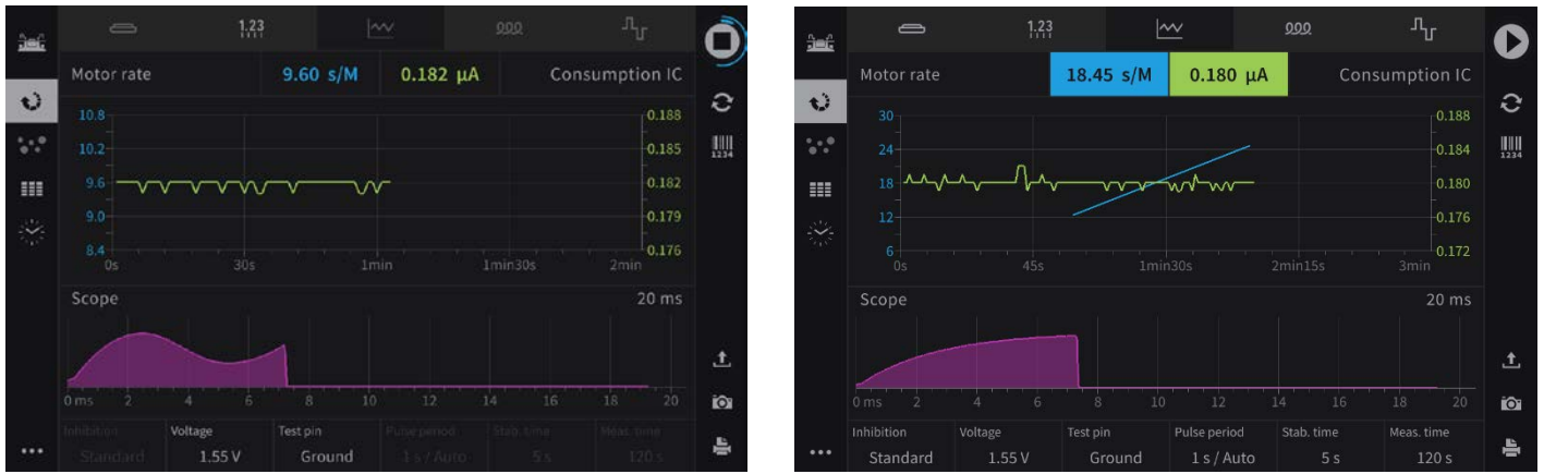
Figure 35: Gauche : mouvement bon sans asservissement. A droite : mouvement problématique sans asservissement.
