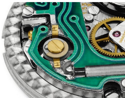
Figure 25: A gauche : Image d'un condensateur variable sur un mouvement. A droite : schéma fonctionnel d'une montre à quartz analogique avec condensateur variable.
