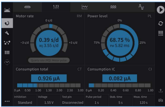
Illustration 33: Mesure de la durée d'impulsion (PW) et de l'asservissement (PL)
